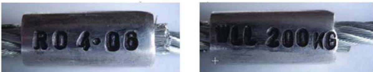
Pic. 10.2.23 ferrule marks; Presshülsekennzeichnungen
