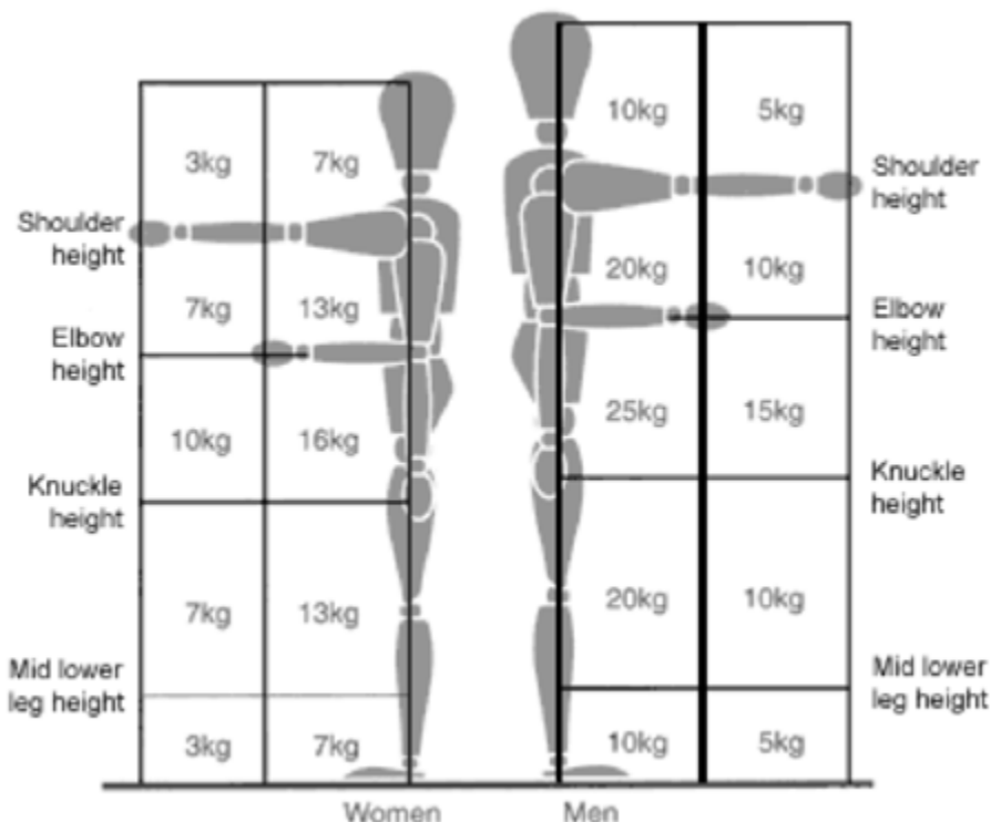
Dia. 3.1-5 acceptable loads 02; zulässige Belastungen 02 Erläuterungen:
