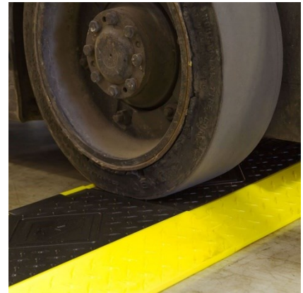
Foto. 6.3.2 Cables under yellow jack
