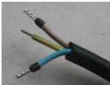
Pic. 07.04.01 1 ferule on stranded wire; Aderendhülsen an einem mehrsträngigen Draht
