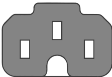
Dia. 07.04.08 CEE 22 en hack och kulle Ett hack och kulle, maximal temperatur: 155 °
